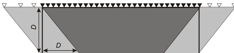
Рис. 5. Планирование профиля ( D – глубинность исследований). Серым цветом показана область уверенного восстановления геоэлектрического разреза без дополнительных измерений (треугольники с заливкой – пункты основных измерений); более светлым тоном – дополнительные области уверенного восстановления геоэлектрического разреза при наличии дополнительных измерений в точках, отмеченных треугольниками без заливки
